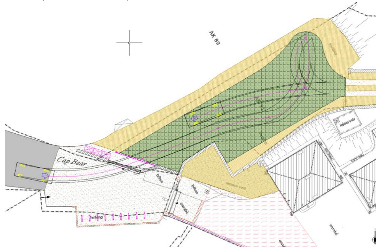
> Surface de dalles alvéolaires en béton et trace de giration de la navette
